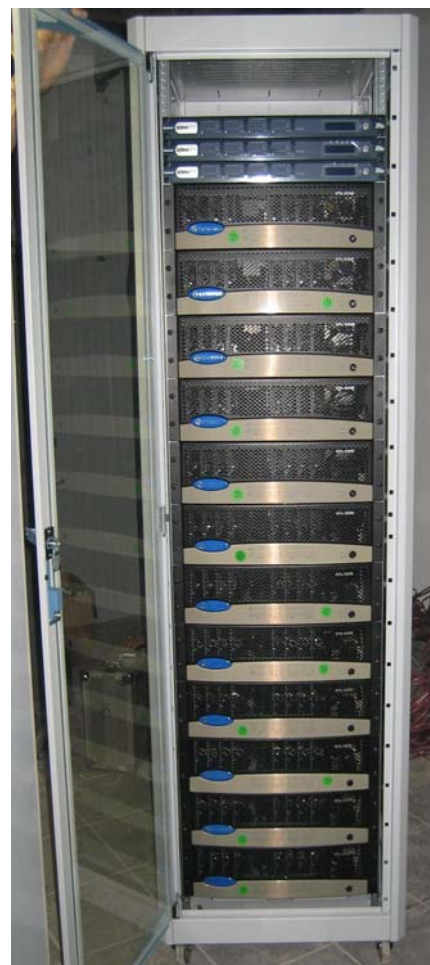
Uno dei rack locali Soundweb London e Crown CTs 8200 durante il set-up
